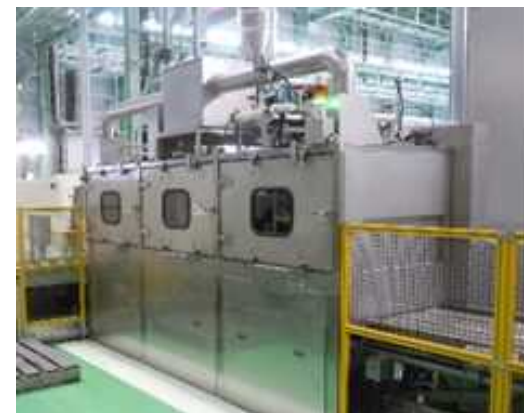
環境負荷を低減できる設備 (導入事例：薬剤を使用しない部品洗浄装置)
